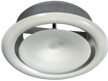
Клапаны SR-P предназначены для применения в приточных системах вентиляции и кондиционирования. Они представляют собой потолочные воздухораспределительные элементы с плавным регулированием расхода воздуха, которое осуществляется с помощью вращения центрального диска.
