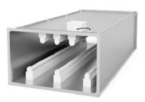
Секция бактерицидная предназначена для обеззараживания воздуха ультрафиолетовым излучением непосредственно в канале воздуховода. Секции монтируется в любом положении. Корпус изготавливается из оцинкованной стали. В качестве ламп применяются бактерицидные газоразрядные ртутные лампы низкого давления, мощностью 75 Вт (питание 230В).
