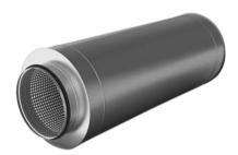
Трубчатый шумоглушитель предназначен для снижения уровня шума от вентиляторов в круглых воздуховодах. Максимальная температура перемещаемого воздухо составляет 70°С. Он выполняется в виде двух круглых воздуховодов из стального оцинкованного листа, вставленных один в другой. Пространство между
